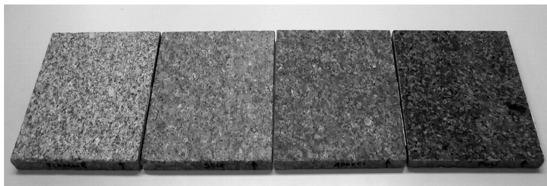
Illustration 9 : Photographie en noir et blanc du même granit rouge en finition flammée, sciée, adoucie ou polie mettant en évidence l'influence de la finition sur la luminance d'un même produit. Source : LER-VP
