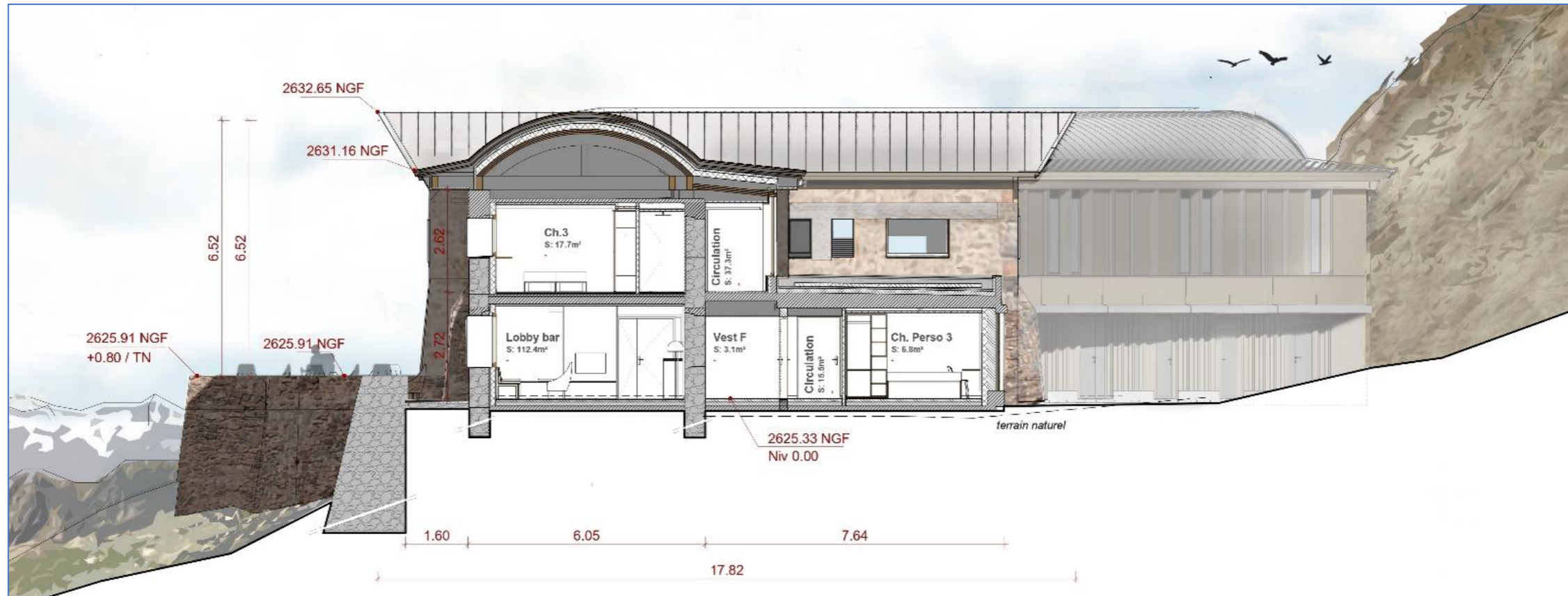
Illustration n° 5 : Coupe sur une chambre courante de l'existant
